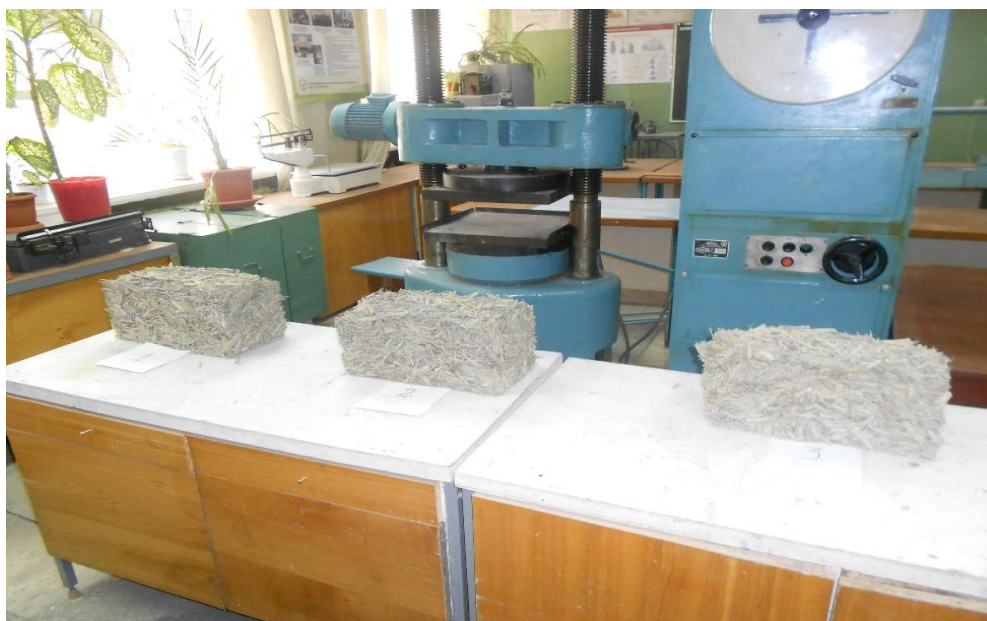
Рисунок 1 - Испытуемые арболитовые блоки в лаборатории
