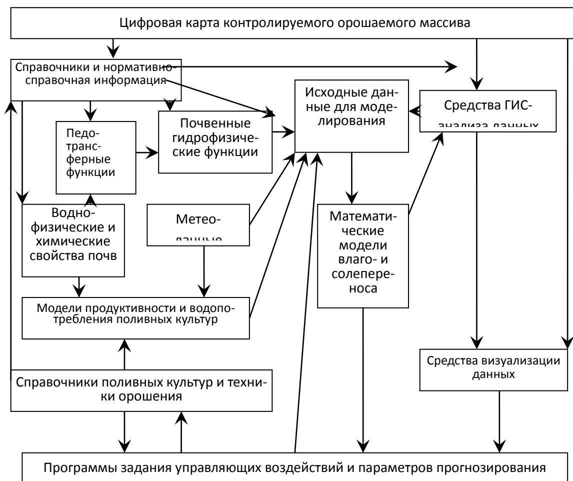
Рисунок 3 - Схема геоинформационной модели мониторинга солевого режима мелиорированных земель
