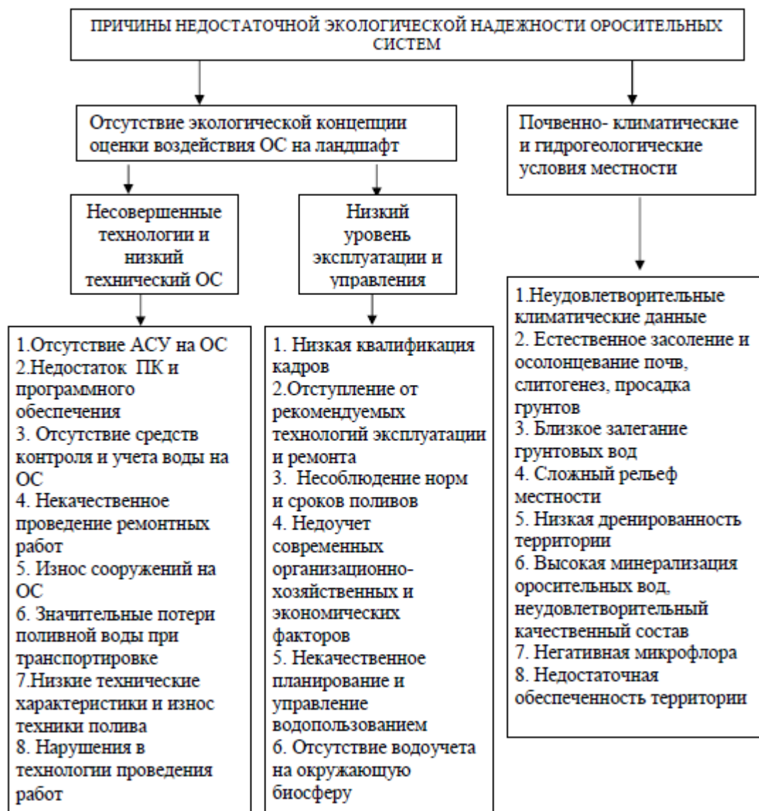
Рисунок 1 - Структурная схема причин недостаточной работы экологической надежности оросительных систем
